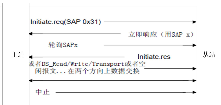
图 10 PROFIBUS-DPV1/C1 读非循环数据通讯机制
