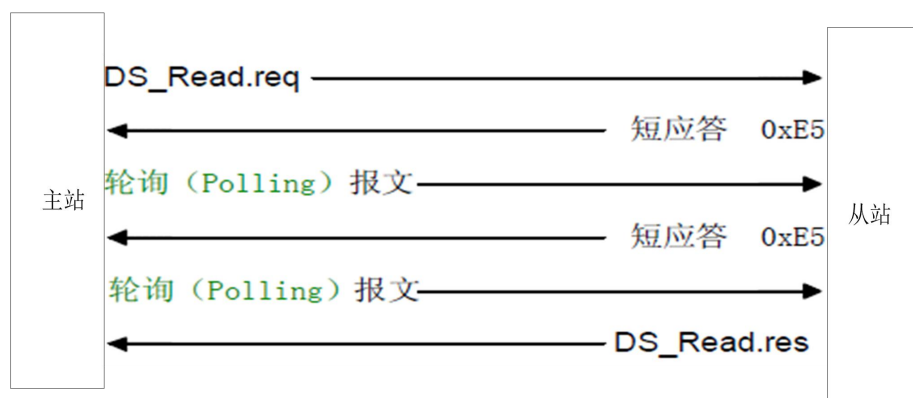
图 9 PROFIBUS-DPV1/C1 读非循环数据通讯机制
